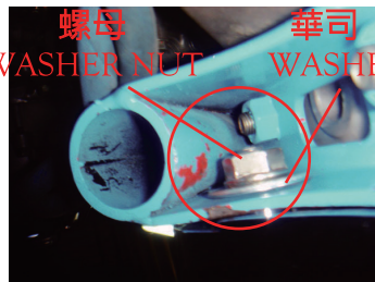
2. 安裝不鏽鋼螺絲 M10*1.25*20 和螺母M10
