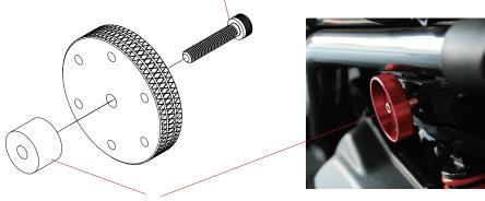
BWS需安裝此套管 φ 6.2x φ 20x14MMx1PC
