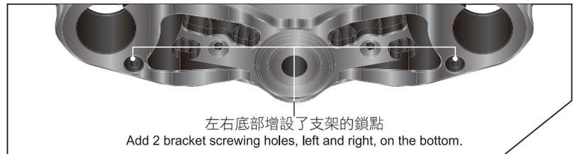
為了維持三角台那精美的外型我們在在三角台的底部增設了各式線束支架的鎖點。
