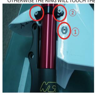
2.AFTER FASTEN THE FENDER (SEE SCREW 1), FASTEN THE RING INTO THE FRONT FORKS (SEE CIRCLE 2).
