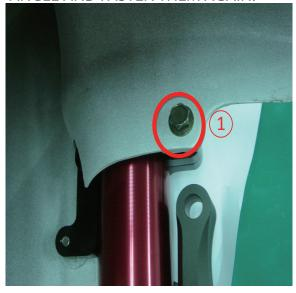
1.USE THE ORIGINAL FENDER SCREWS (SEE CIRCLE 1) TO FASTEN THE FENDER AND THE FRONT FORKS RING FIRST.
